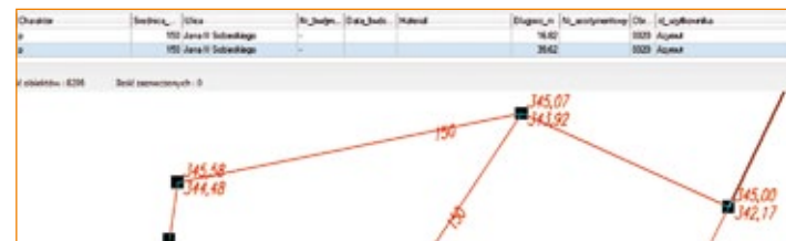
Dane graficzne i opisowe przyłącza kanalizacyjnego wprowadzone w programie C-GEO (Softline)
