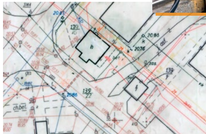
Fragment skanu typowej mapy zasadniczej (podkład skalibrowany w programie C-GEO firmy Softline)
